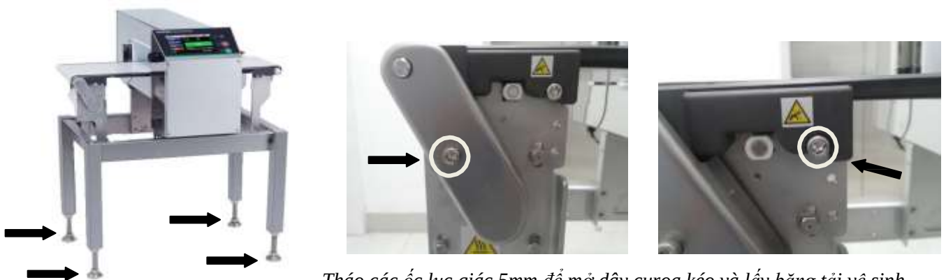
Tháo các ốc lục giác 5mm để mở dây curoa kéo và lấy băng tải vệ sinh
